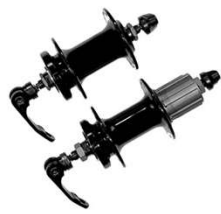
Cubo Freio Disco Dt/ts Rolamento Alum K7 At e 12v GTS 36f C/bloca
